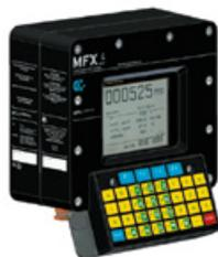
El **Terminal MFX\_4** es la Interfaz hombre-máquina (MMI), a través de la cual se efectúa la comunicación con el controlador, otros terminales adecuados o un Sistema Scada. Con el fin de garantizar un funcionamiento óptimo, está equipada con una pantalla gráfica configurable, capaz de mostrar todos los datos de proceso en varios tamaños e idiomas.
